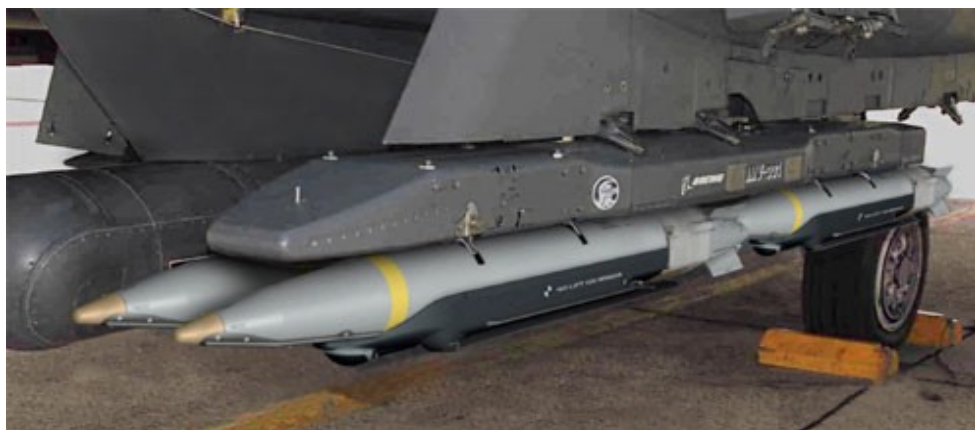
Unterflügelstation einer F-15 mit mit zwei GBU-39 Bomben / GBU = Guided Bomb Unit (Wikipedia)
