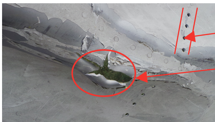
Фото 22. Характер повреждений обшивки Boeing 777
